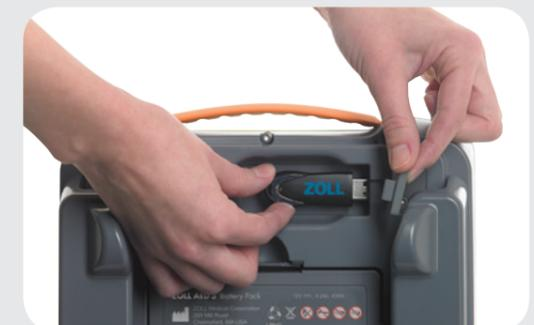
Branchez un clé USB dans le port USB pour télécharger les données d'événements de RCP, charger une nouvelle configuration ou mettre le logiciel à niveau.
