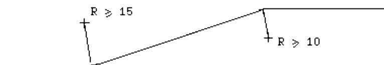
Figure 9 Raccordement des pentes
